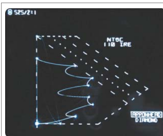
Figura 64. Visualizzazione Tektronix Arrowhead, barre colore dei componenti al 75% per NTSC.
